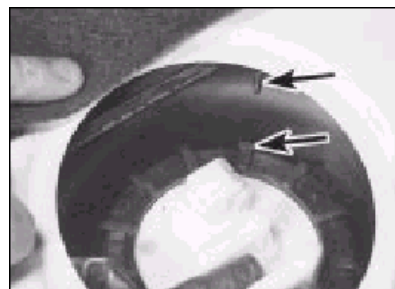
9.21 Při montáži utáhněte zajišťovací kroužek až je přesně srovnaný se znaménkem na palivové nádrži (šipka)
