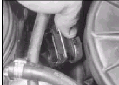
12.3a Odpojte konektor ze snímače škrticí klapky . . .
