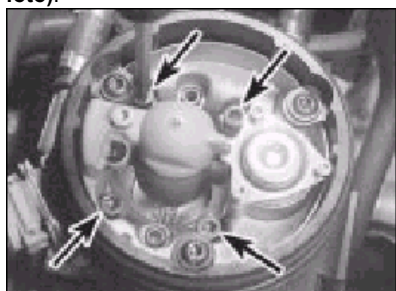
12.7 Šrouby těla škrticí klapky (šipka) na systému Bosch Monopoint.
