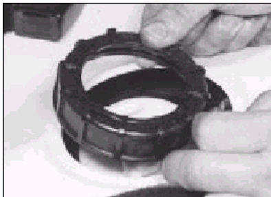
9.11 Vyšroubujte zajišťovací kroužek. .
