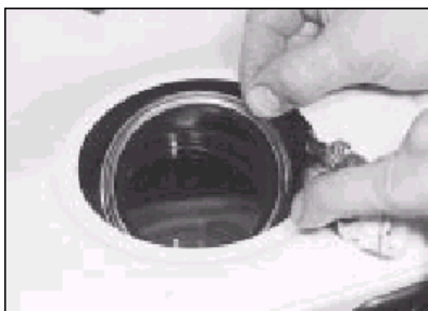
9.12b . . . a vyměňte gumové těsnění
